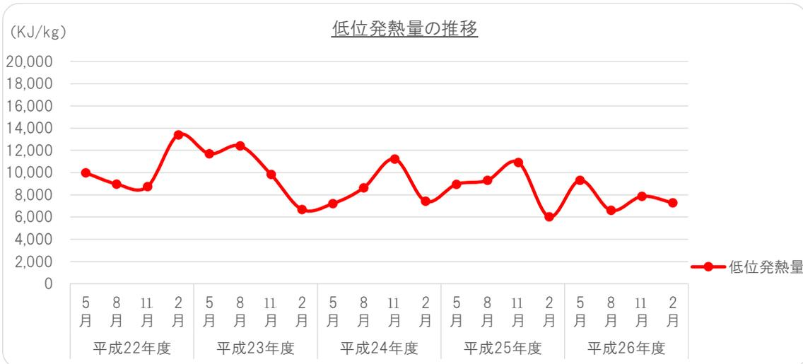
\* 低位発熱量(=真発熱量)とは、ボンブ熱量計で測った高位発熱量(=総発熱量)から水分が奪う熱量(蒸発潜熱)及び水素が水になって奪う熱量を差し引いた値を差し、実際に利用できる熱量を示す値のことをいいます。
