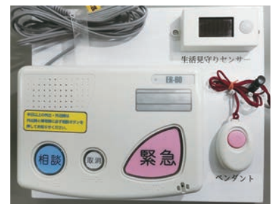
緊急通報装置
