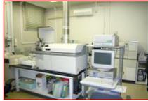
重金属類検査用ICP-MS
