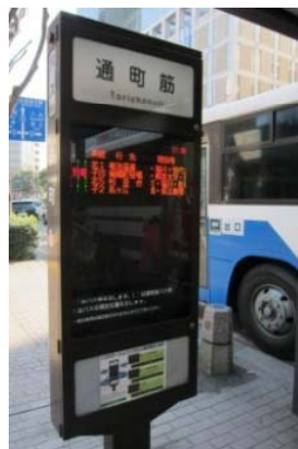
▼バスロケーション(接近表示)システム の例(熊本市での事例)
