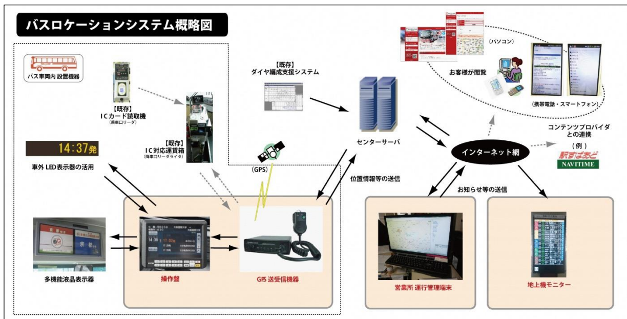
図 バスロケーションシステム概略図
