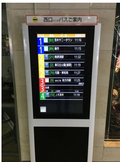
図 バスロケーションシステム対応の案内モニター（阪急茨木市駅）
