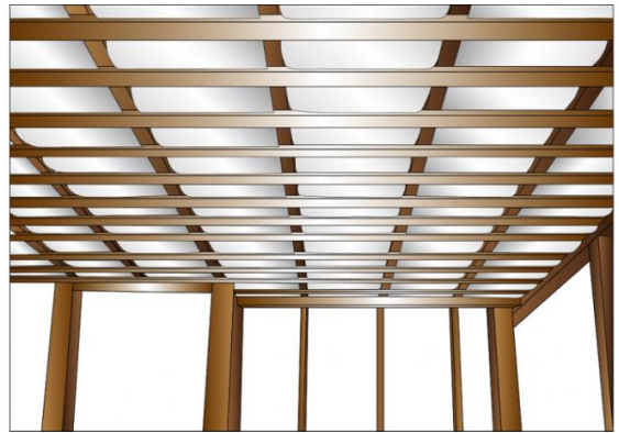
6. 天井 (屋根) 断熱材 (居間)
