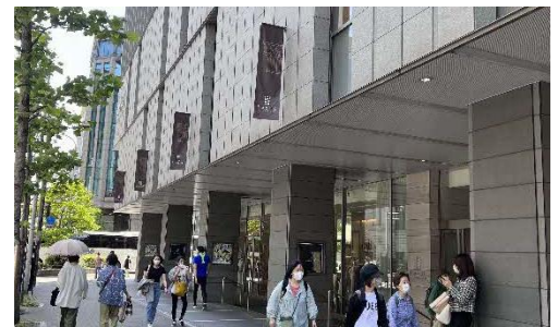
通行や通りの見通しを妨げないように壁面に広告旗を掲出している事例
