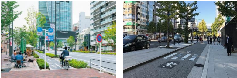
▲歩行者・自転車・自動車の動線が分離されている事例 (東京都港区/新虎通り、大阪市/御堂筋)
