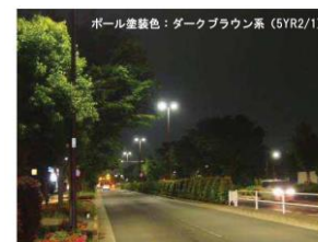
ポール塗装色：ダークブラウン系 (SYR2/1) ■暗色は夜間景観でも照明柱が主張されることはない
