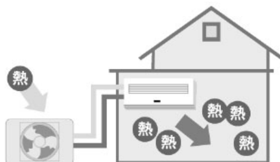
図 ヒートポンプの図 ( NEDO )
