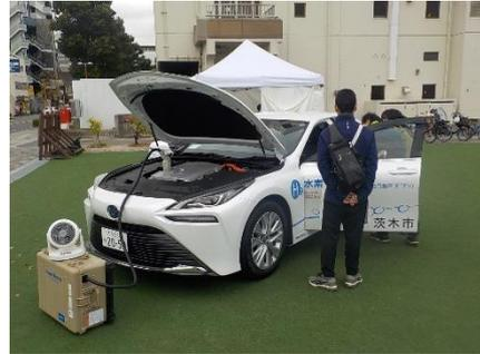
燃料電池自動車 MIRAI と可搬型給電器
