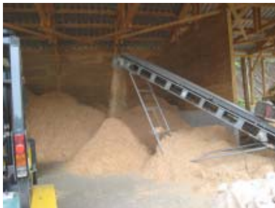
チップ燃料の製造現場
