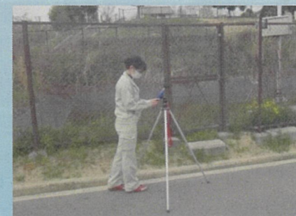
環境騒音調査の様子
