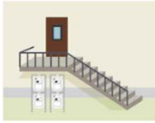
階段下に集中設置の例
