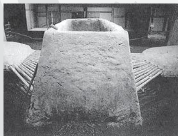
「炉」(鉄を取り出す際に本来は破壊する)
