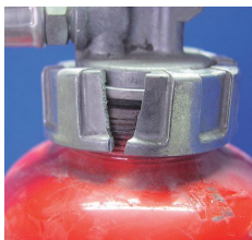
× キャップの破損
