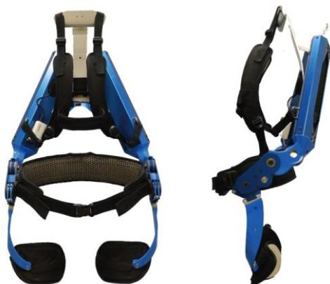
空気圧式の人工筋肉が介助者を補助し、持ち上げる際の腰への負担を軽減。（1事業所）
