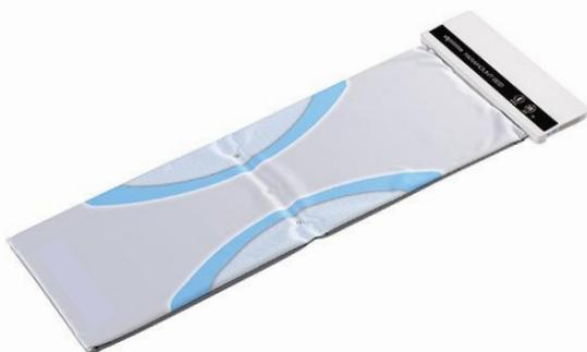
通信機器に接続されたセンサーをベッドに敷き、パソコンやタブレット端末で被介護者の起き上がりや離床・在床を把握。（1事業所）
